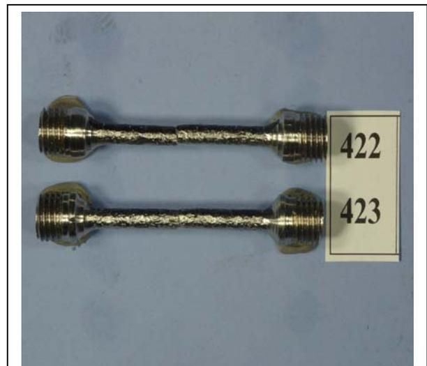
Fig. 6. Tensile test for diffusion bonded alloy 617.
