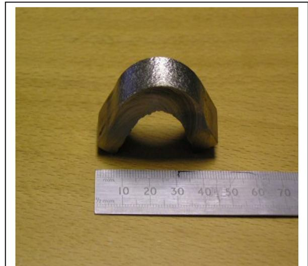
Fig. 5. Bend test for diffusion bonded alloy 617.
